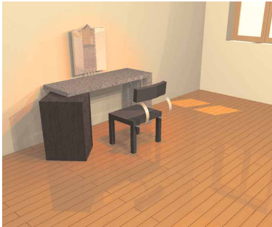
Επιφάνεια με γεωμετρία παρκέ 1,5*0,20, υπέρθεση υλικού-αρχείο bmp, και απόδοση έτοιμων ιδιοτήτων - ανάκλαση, συγκέντρωση ανακλάσεων, καθρεπτισμός
