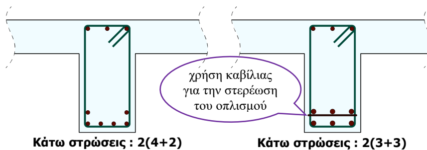
Σχήμα 2.2: Χρήση καβίλιας για την στερέωση του οπλισμού στην περίπτωση της 2 ης στρώσης με 3
